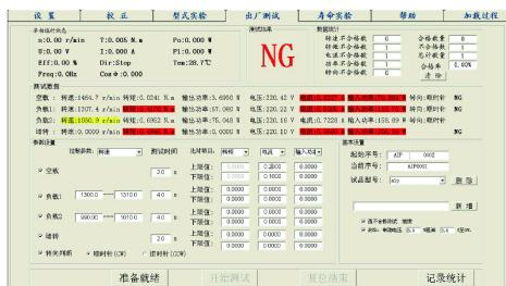
● 測試項目：電壓、電流、輸出入功率、效率、扭力、轉速
